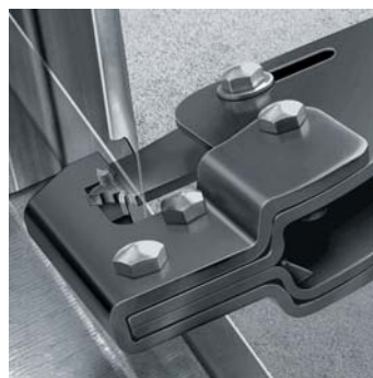
Пуансон инструмента продавливается через профили
