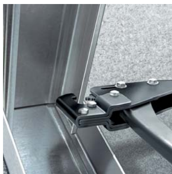
Установка инструмента на оба соединяемых профиля
